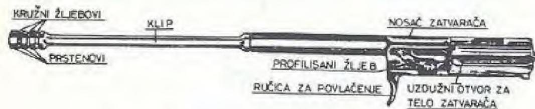
Sl. 10 – Delovi nosača zatvarača i klipa
